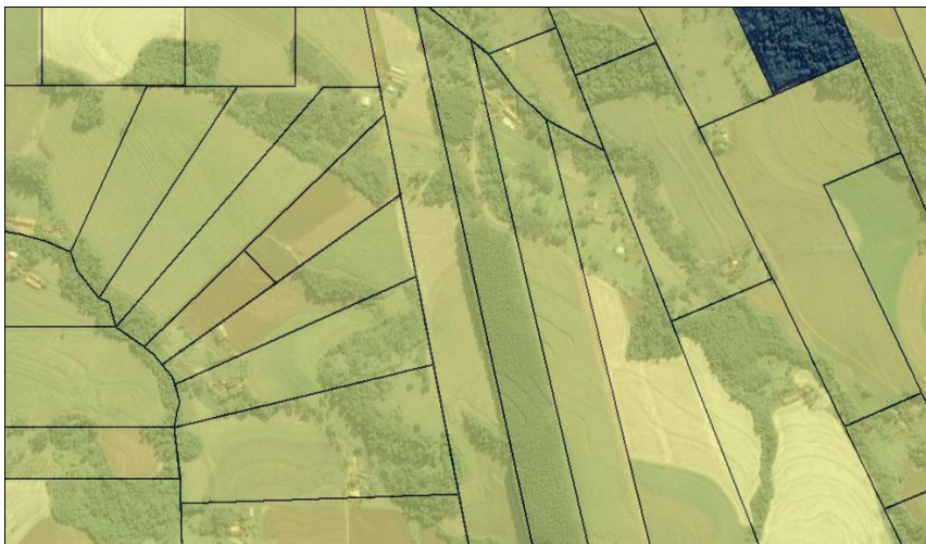
Figura 8. Limites dos imóveis corrigidos com base na imagem de satélite.
